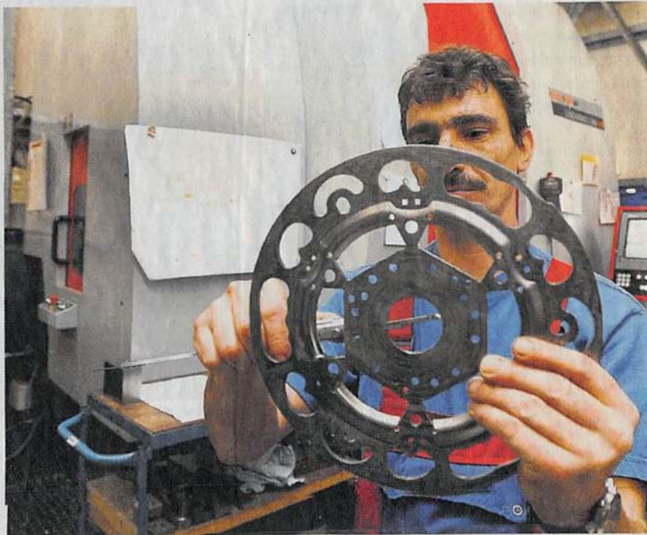
Der CNC-Fräser Holm Jänichen kontrolliert die Maße einer Bremscheibe. Die Oederaner Brand Werkzeug- und Maschinenbau GmbH beliefert auch Hersteller von Automobilzubehör mit Werkzeugen und Bauteilen. FOTO: TONI SÖLL
